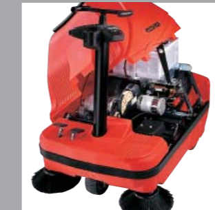
2 kraftvolle 24 V-Motoren mit insgesamt 900 W. 2 powerful 24 V-engines with a total of 900 W.
